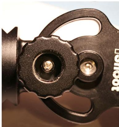
Une fois la vis M3 déposée la molette peut être dévissée complètement et l'arbre de serrage enlevé. Les rondelles nylon sont en deux tailles et si ce n'est pas critique il sera préférable d'éviter d'intervertir les surfaces de contact.
